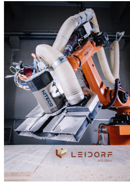
Leidorf setzt beim Abbund auf einen Roboter, bestückt mit einer Hightech-Spindel von Hiteco (Modell QM aus der Robotech-Serie)
