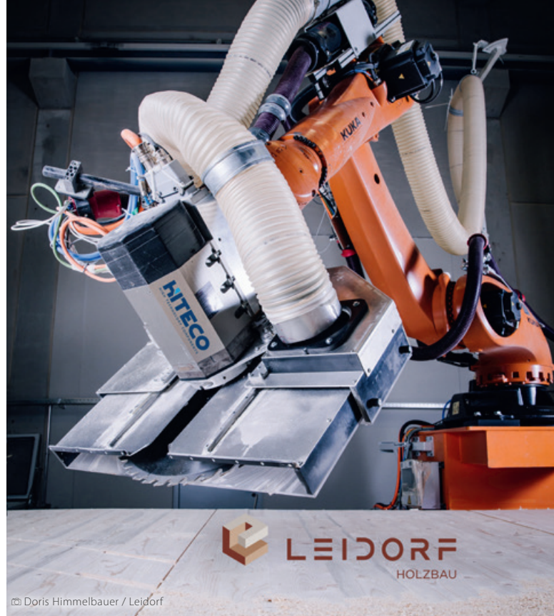
Roboter-CNC-Anlage des Unternehmens Leidorf mit einer Hiteco Robotech SM-Frässpindel mit 900 mm Sägeblatt
